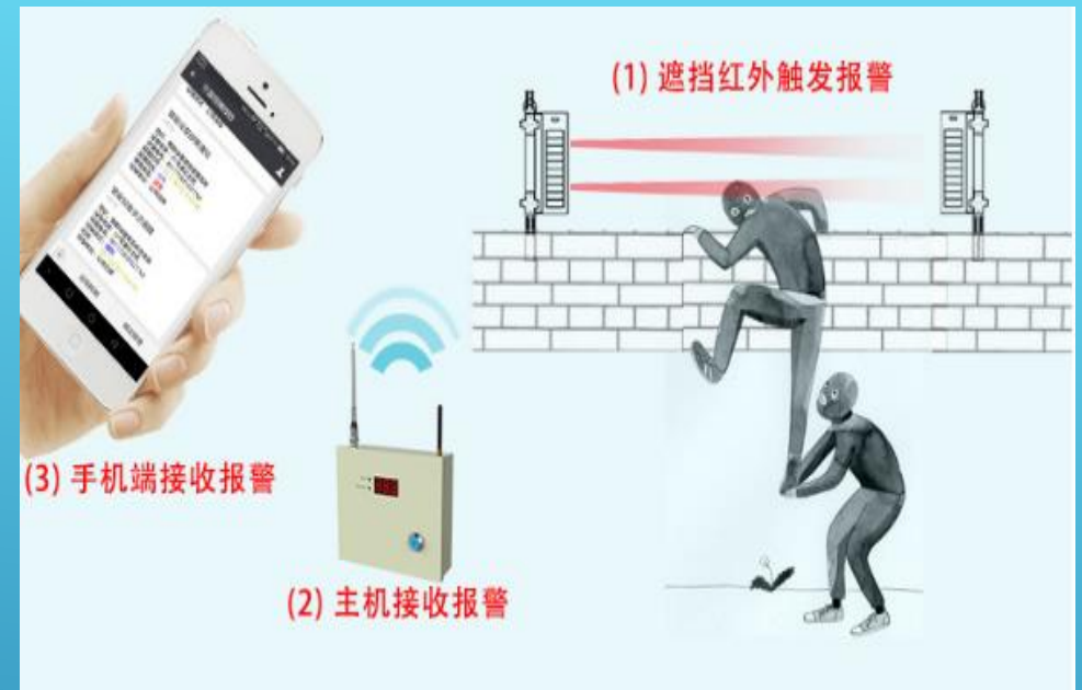
太阳能红外电子围栏系统
